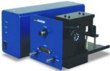
Ayrıca ETCS-761 model cell holder ile numune sıcaklığını hassas bir şekilde korumak için Peltier etkisi kullanılır. Bu aksesuar, daha geniş bir sıcaklık aralığı için su soğutmalı Peltier aksesuarıdır.
